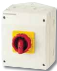
COMO CS enclosure 25 to 100 A Polycarbonate - IP65
