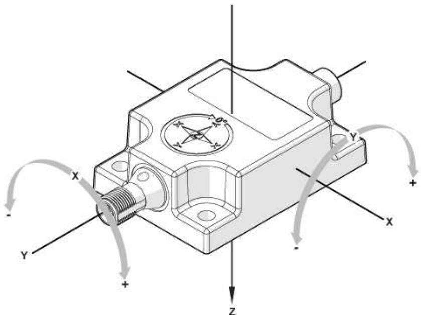
horizontale Einbaulage / Rotation um X- und Y-Achse
