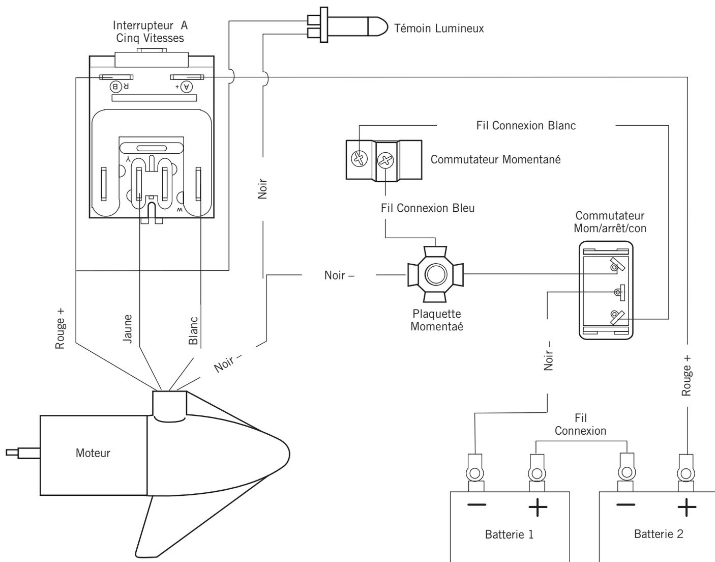
**AVIS :** Il s'agit d'un schéma multitenion. Revérifiez la tension de votre moteur afin d'effectuer les raccordements appropriés. Les dispositifs de protection contre la surintensité ne figurent pas dans cette illustration.
