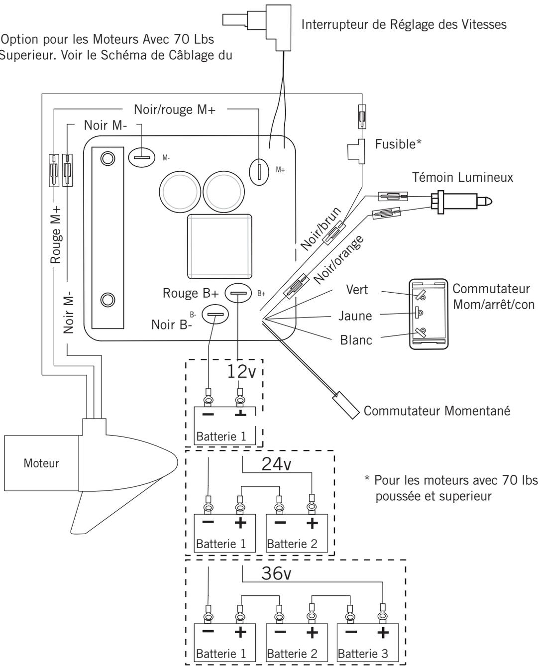
**AVIS :** Il s'agit d'un schéma multitenion. Revérifiez la tension de votre moteur afin d'effectuer les raccordements appropriés. Les dispositifs de protection contre la surintensité ne figurent pas dans cette illustration.
