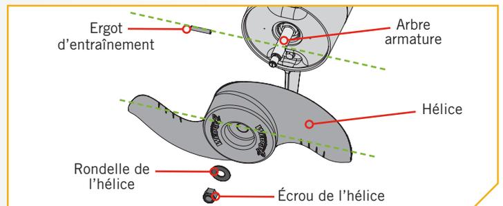
**AVIS :** Si l'ergot d'entraînement est cisaillé ou cassé, tenez l'arbre stable à l'aide d'une lame de tournevis enfoncée dans la fente à l'extrémité de l'arbre pendant que vous desserrez l'écrou de l'hélice.
